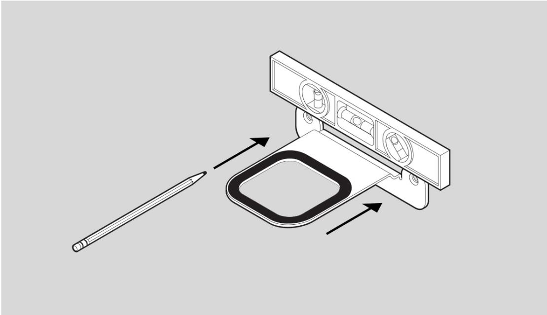
2. Beim Einsatz von Mauerdübeln verwende zum Vorbohren der beiden Löcher einen 8-mm-Bohrer und setze anschließend die Mauerdübel ein. Nähere Informationen zur Wandmontage findest du unten. Andernfalls überspringe diesen Schritt.
