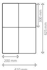
Unsichtbarer Lautsprecher für den Einbau in Decke und Wand. Eine Grundierung erlaubt den Einbau unter Putz oder Farbe oder Verklebung.
